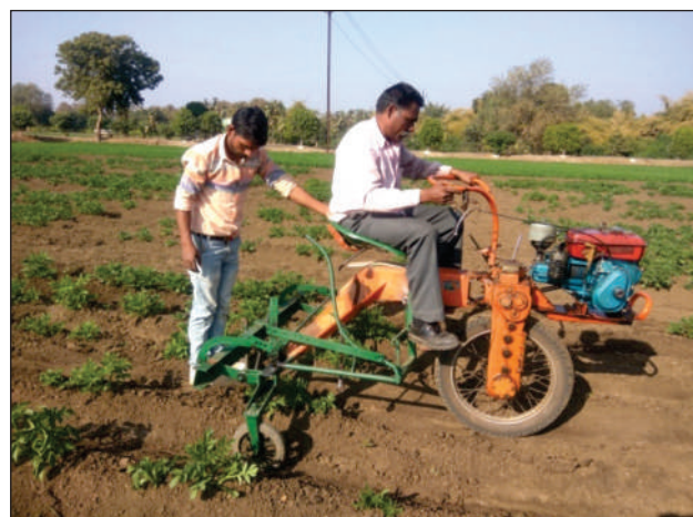
चित्र 1.19: निदेशालय में विकसित निंदाई यंत्र का चने एवं आलू के खेत में परीक्षण
