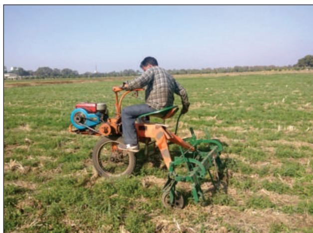
चित्र 1.19: निदेशालय में विकसित निंदाई यंत्र का चने एवं आलू के खेत में परीक्षण
