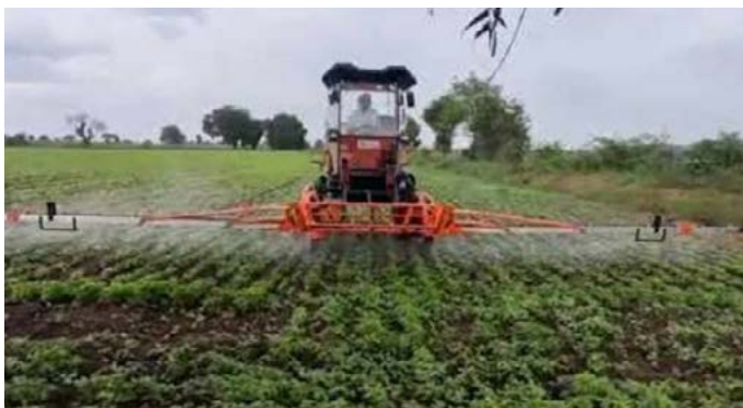
चित्र 3: हाई क्लीयरेंस ट्रेक्टर चलित बूम स्प्रेयर
