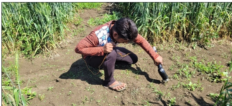
चित्र 2.5: खेत में काम करने वाला विकसित बैटरी चालित हस्तचालित वीडर Fig. 2.5: Developed battery operated hand held weeder operating in field
