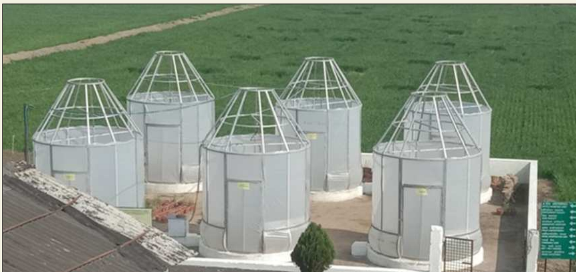
चित्र 1: उन्नत ओपन टॉप चेम्बर (OTC) सेटअप: नियंत्रित वातावरण में जलवायु परिवर्तन के घटकों (जैसे CO 2 , तापमान) तथा फसल-खरपतवार पारस्परिक क्रियाओं और शाकनाशी प्रभावशीलता पर अध्ययन करने हेतु स्थापित संरचनाएँ।
