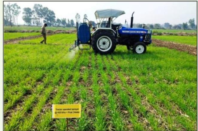
चित्र 2. गेहूँ की फसल में ट्रैक्टर चालित बूम स्प्रेयर द्वारा खरपतवारनाशी का छिड़काव
